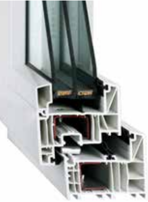
Kunststoffenster mit 6-Kammer-Profil und 3-fach Isolierverglasung, U_g=0,5 \text{ W/(m}^2\text{K)} , weiß
