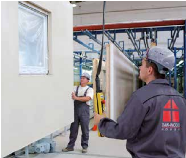
Die Wände werden in der Fabrik vorgefertigt...
